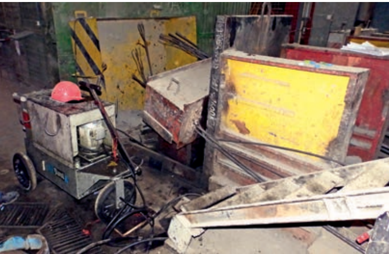
Fot. 2. Na pierwszym planie hydrauliczny agregat pompowo-silnikowy, z którego był tłoczony olej hydrauliczny do siłowników przesuwających belkę oporową. Po prawej stronie są widoczne blok oporowy oraz oparta o płytę belka oporowa (która została wyrzucona nad siłownikami i skrzyniami siłowników)
