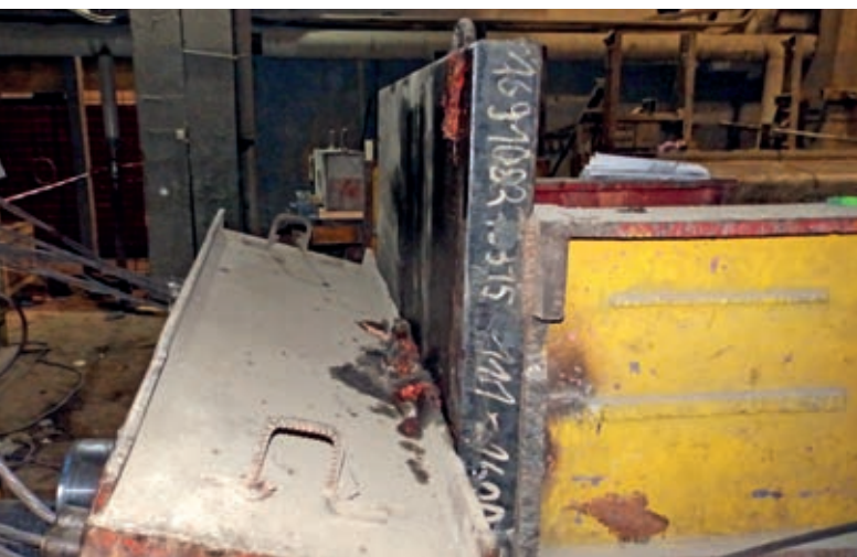
Fot. 6. Widok belki oporowej opartej o płytę bloku oporowego (zdjęcie wykonane od strony agregatu hydraulicznego). Belka, uderzając o płytę bloku oporowego, spowodowała zmiążdżenie i urwanie prawej nogi uszkodzonego
