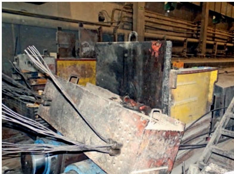
Fot. 1. Na pierwszym planie widoczna jest belka oporowa, która w momencie zdarzenia została przetrzebiona nad siłownikami i uderzyła w metalowy blok oporowy. Belka leży na nieruchomych metalowych elementach skrzyń, w których umieszczone są siłowniki. Widoczne liny sprężające zakotwiczone w belce oporowej (8 szt.)
