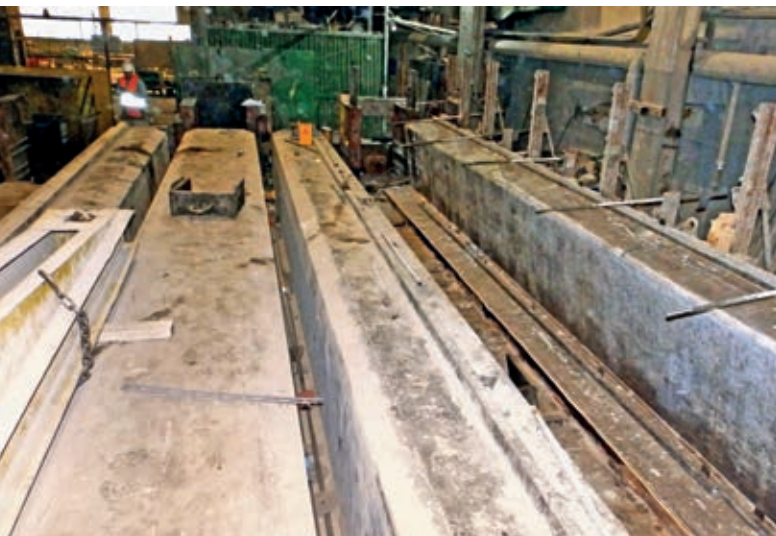
Fot. 5. Forma na torze naciągowym
